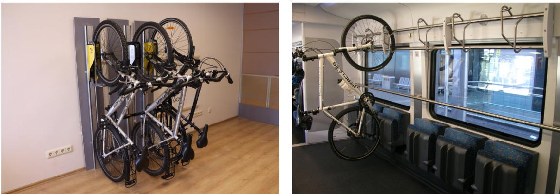
Abbildung 0-10: Fahrradlift (links) und Umgestaltung Fahrradabteil (Quelle: ÖBB-PV)
