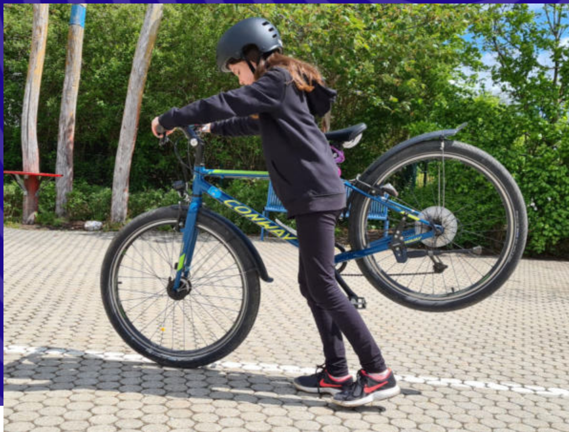
Bremsencheck, Vorderradbremse Fotos: Ökoprojekt MobilSpiel e.V
