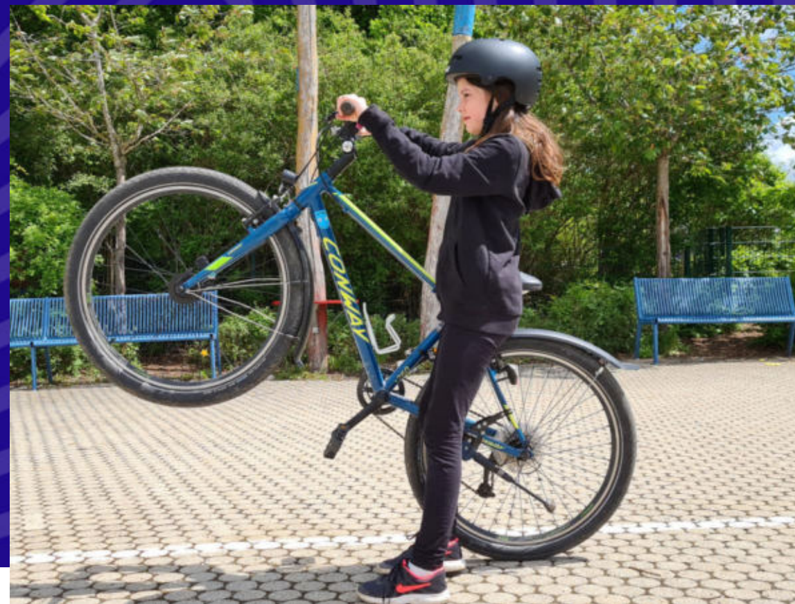
Bremsencheck, Hinterradbremse Foto: Ökoprojekt MobilSpiel e.V
